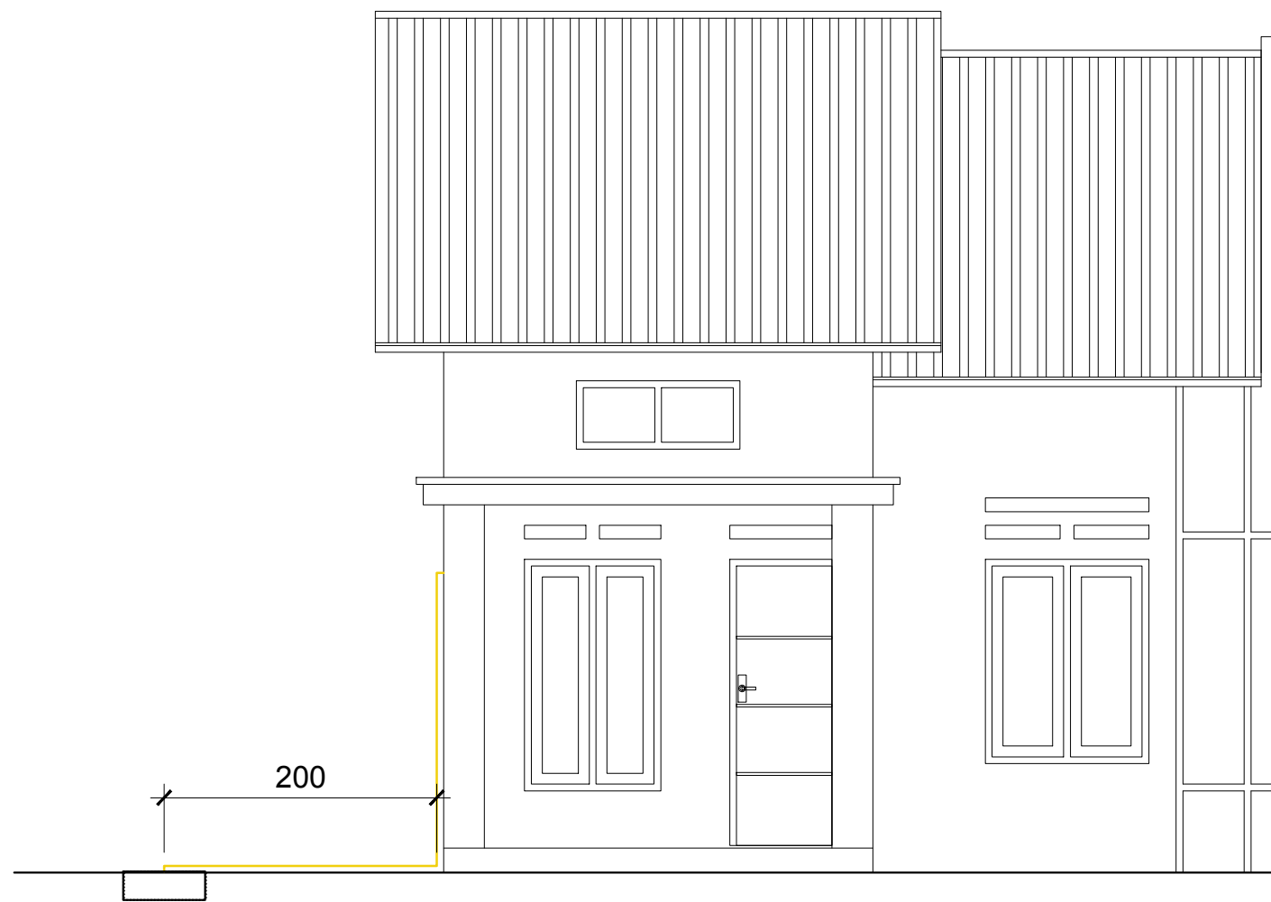
RENCANA SISTEM PEMBUMIAN SKALA 1 : 50
